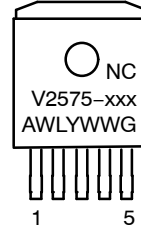
D 2 PAK D2T SUFFIX CASE 936A
