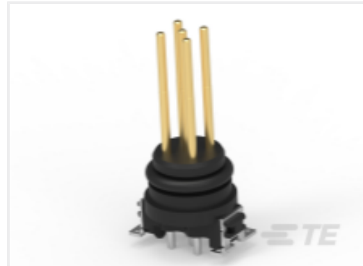
TE Part # 494100-E M12 MALE, UNI CODE, 5P, 10.5MM THR, DI
