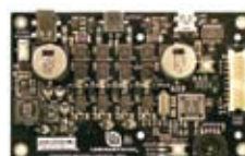
Stellaris Stepper Motor Module
