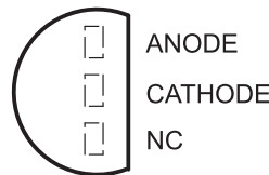
LM285-1.2, LM385-1.2, LM385B-1.2 . . . LP PACKAGE (TOP VIEW)
