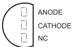
LM285-1.2, LM385-1.2, LM385B-1.2 . . . LP PACKAGE (TOP VIEW)
