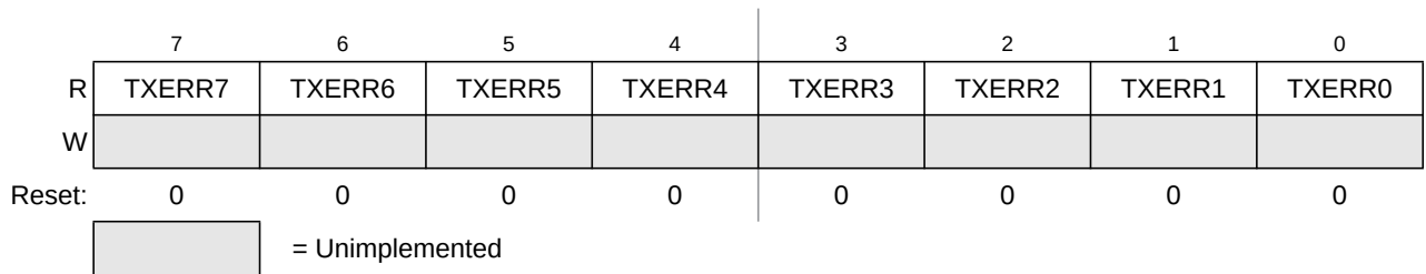
Figure 10-19. MSCAN Transmit Error Counter (CANTXERR)
