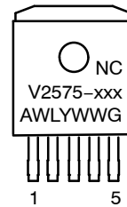
D 2 PAK D2T SUFFIX CASE 936A
